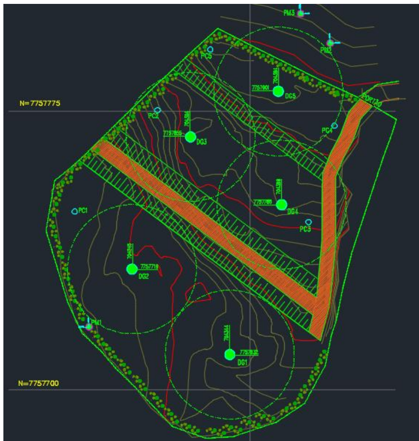
Figura-1: Sistema de drenagem de chorume
